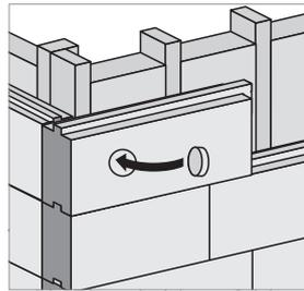
Bevor die Holzfaser-Dämmplatten mit einer Putzbeschichtung versehen werden, muss folgendes beachtet werden: Wird dahinter in das Gefach ein Einblasdämmstoff eingebracht, muss dieser vollständig, setzungssicher und hohlraumfrei eingeblasen werden.
