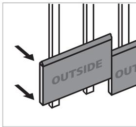
Profilierte Platten werden mit der Feder nach oben montiert. Die Stempelung auf den Platten gibt die Verlegeseite an. Zur Verschnittoptimierung können alle STEICO Putzträgerplatten gedreht werden.
