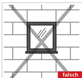
Bei der Montage der STEICO Putzträgerplatten im Fenster- oder Türenbereich ist darauf zu achten, dass die Platten weder vertikal noch horizontal direkt in den Öffnungsecken gestoßen werden, sondern um ein Maß von mind. 15 cm versetzt werden (Revolverschnitt). Hierdurch wird Spannungskonzentrationen in der Dämmplattenebene entgegengewirkt. (Die zusätzliche
