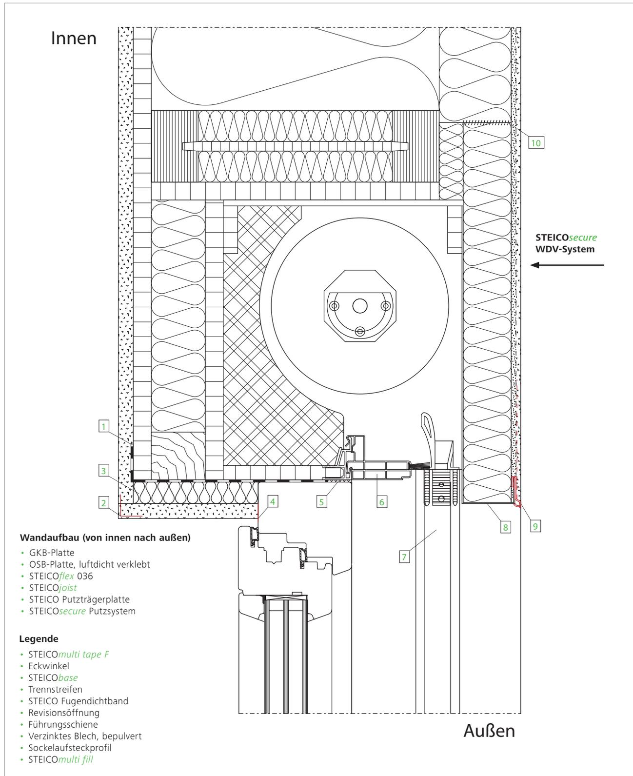
Raffstore-Fenster: Oberer Anschluss mit Laibungsplatte 20 mm
