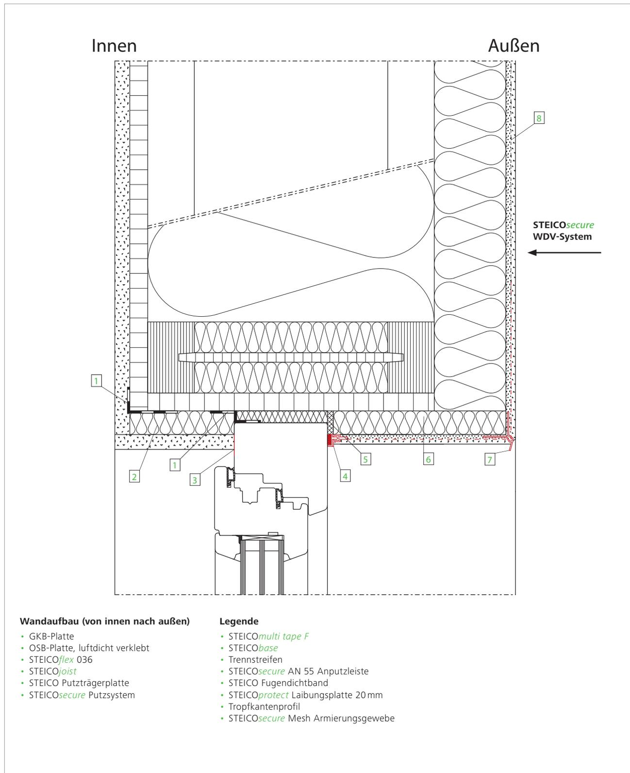
Fenster: Unterer Anschluss mit STEICO*fix* 2.0 Holzfaser-Dämmkeil
