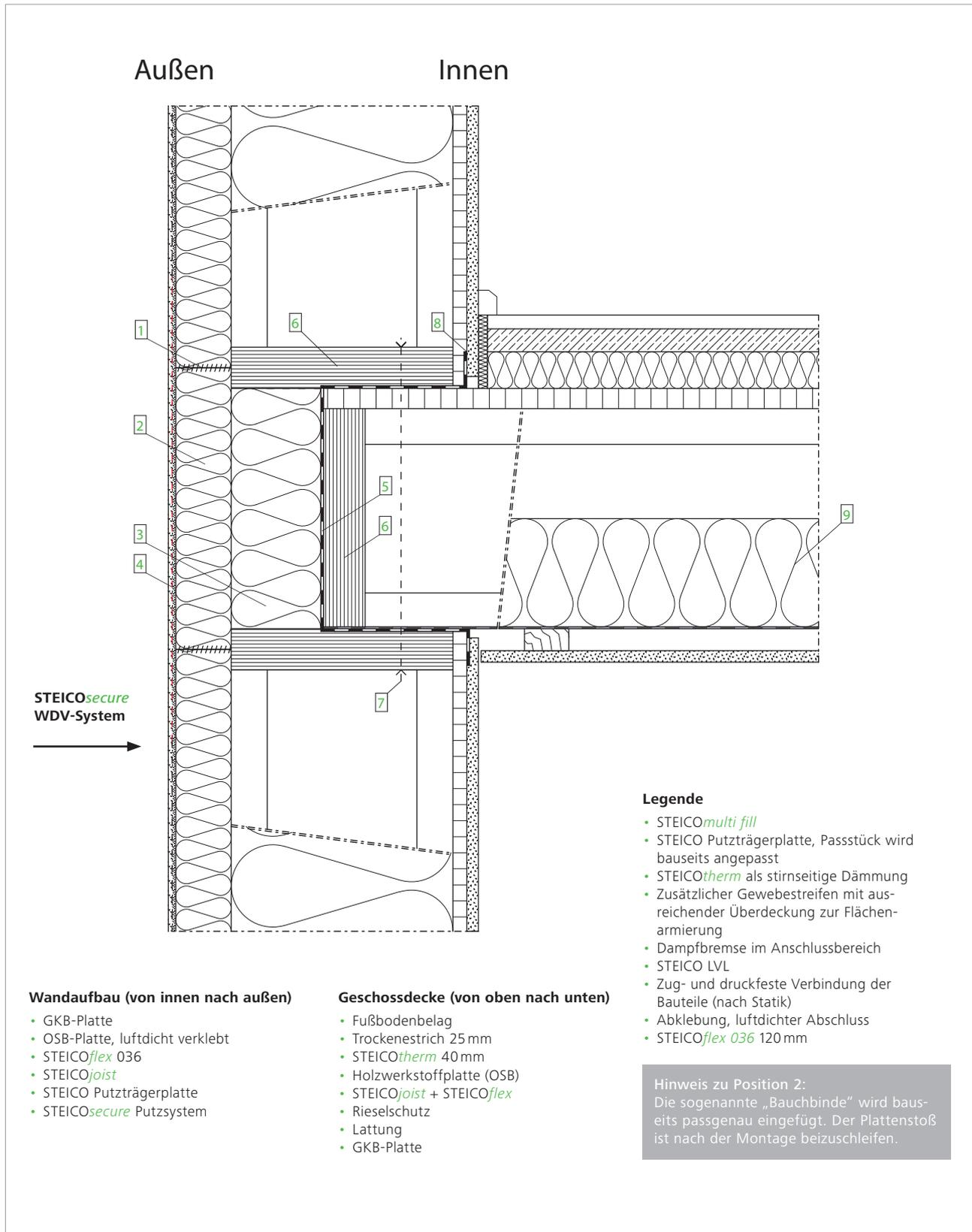
Außenwand / Geschosdecke: Aufstockung Holzrahmenbau, gedämmtes Mauerwerk, flächenbündig (Rücksprung MW)
