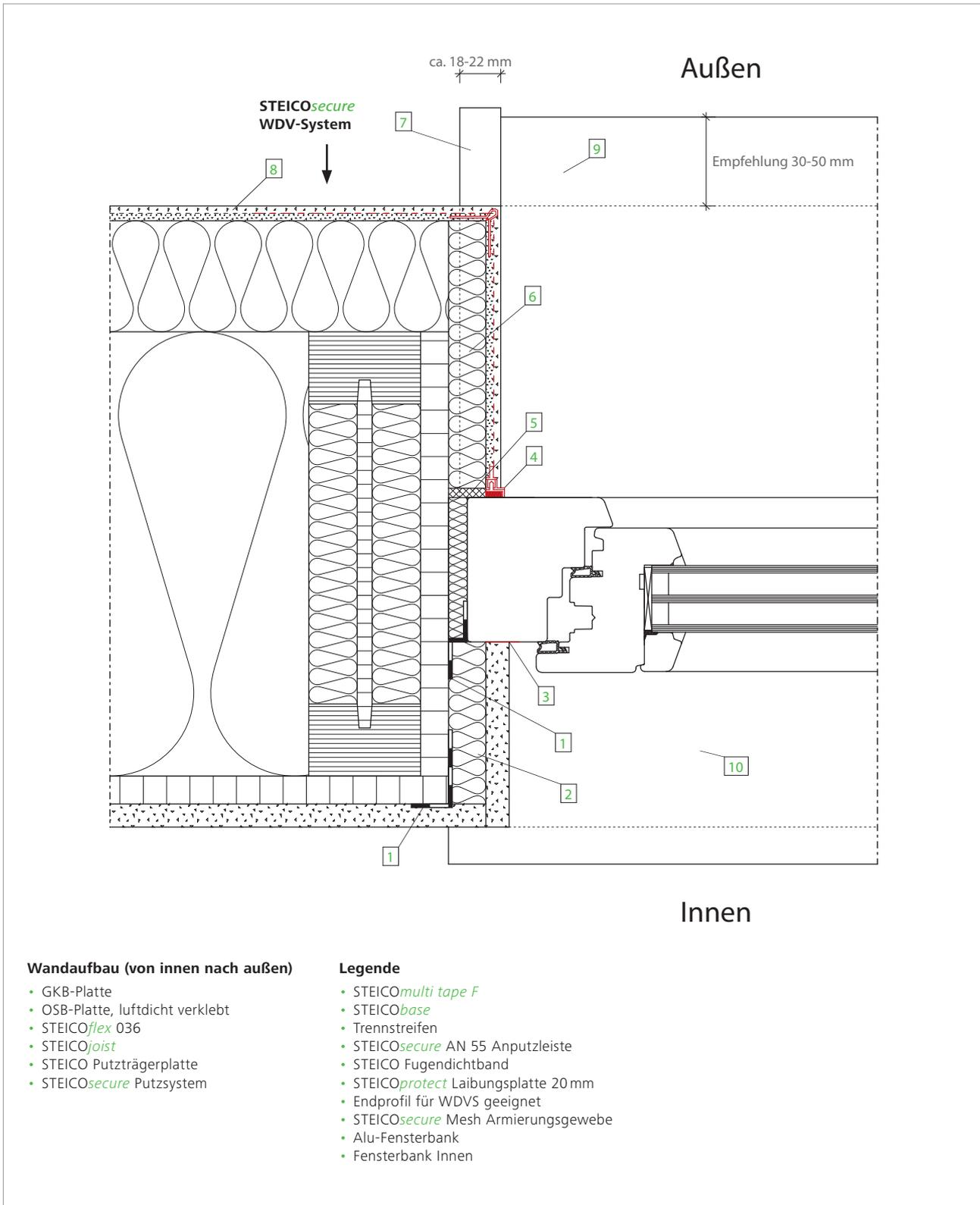
Fenster: Seitlicher Anschluss mit Laibungsplatte 20 mm
