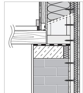
Wird eine durchgängige Putzschicht gewünscht, so ist folgendes Vorgehen sinnvoll: Der Holzbau der Aufstockung (Außenkante des Holzrahmenwerks) ist mit dem massiven Bestand bündig zu setzen. Auf die Stiele des Holzrahmenbaus werden Konstruktionshölzer mind. 6\*6 cm aufgeschraubt, die in den Massivbau ragen und mit diesem verdübelt werden. Dabei sind die Stöße der 6\*6 cm Kanthölzer in der Höhe zu versetzen. Anschließend wird das Gefach, das an der gesamten Fassade entstanden ist, mit
