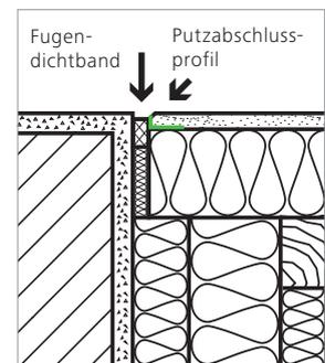
Plattenkante eingebaut, um einen Wassereintritt zu verhindern. Zur Putztrennung dient das STEICO Putzabschlussprofil. Mit ihm kann eine definierte Fuge ausgebildet werden.
