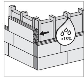
Vor dem Verputzen ist eine Grenzfeuchte der Holzfasер-Dämmplatte von 13 Masse-% einzuhalten.
