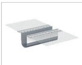
Zur Montagehilfe kann ein Dämmstoffstreifen in die Fuge eingesetzt werden. So kann beidseitig angearbeitet werden und das Schlaufenprofil wird vor Verunreinigung geschützt. Nach dem Erhärten des Oberputzes entfernen.
