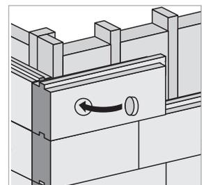
Rückseite der Eckplatten notwendig. Eine Verbindung der Wandelemente kann mit dem STEICO *Verschlussstopfen* 50 mm verschlossen werden.
